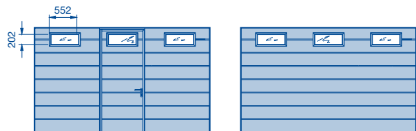
Przeszklenie typu M
